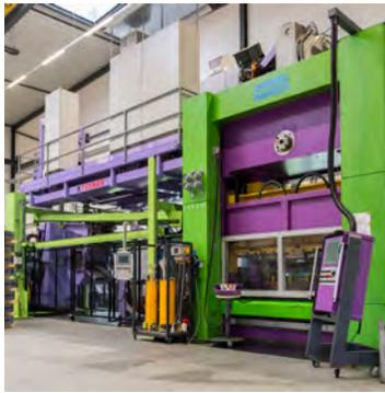
Mit Stanzautomaten (10 bis 400 Tonnen Presskraft), Einlegepressen (bis 150 Tonnen Presskraft) und Hydraulikpressen (bis 160 Tonnen Presskraft) fertigen wir auf dem neusten Stand der Technik, nach Kundenwunsch und mit großer Sorgfalt von der Klein- bis zur Großserie.
