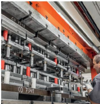
Mit Stanzautomaten (10 bis 400 Tonnen Presskraft), Einlegepressen (bis 150 Tonnen Presskraft) und Hydraulikpressen (bis 160 Tonnen Presskraft) fertigen wir auf dem neusten Stand der Technik, nach Kundenwunsch und mit großer Sorgfalt von der Klein- bis zur Großserie.
